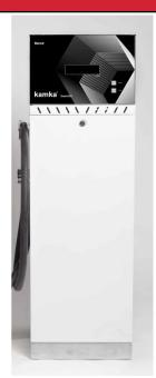
ТРК kamka 5111-01 Smart GO (всасывающая гидравлика, 1 вида топлива, однострочная индикация, 1 рукав 4 м, производительность 50 л/мин., автоматический кран, питание 380 В, счётчик с погрешностью +/- 0,25%). Отпуск топлива клавишами Старт – Стоп, возможен отпуск топлива с помощью ПО. С маркировкой вида топлива.
