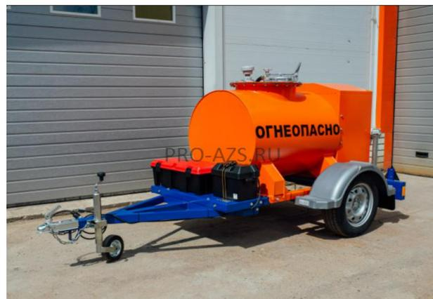
Мобильный топливный модуль, мини АЗС, объемом 500 литров для заправки спецтехники (трактор, бульдозер, комбайн, кран) и прочих автомобилей
